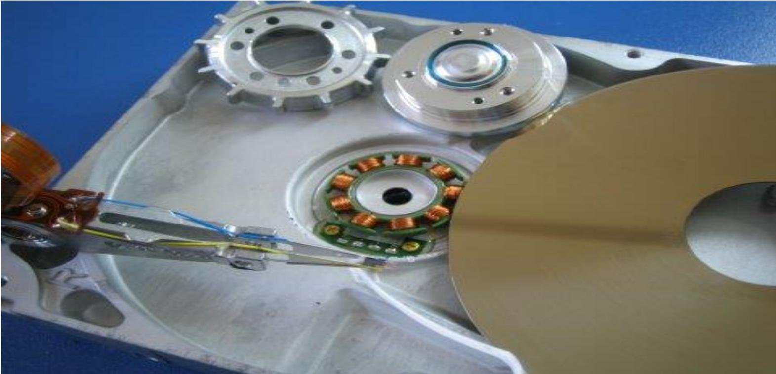
Aqui temos o mesmo HD da foto anterior completamente desmontado, mostrando o interior do motor de rotação.
